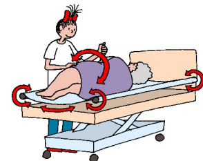
Afbeelding 1a, 1b en 1c: Het Draaibed waarmee een cliënt automatisch passief zijwaarts verplaatst en gedraaid kan worden. De laken wordt onder de cliënt doorgetrokken waardoor hij of zij zijwaarts wordt verplaatst.
