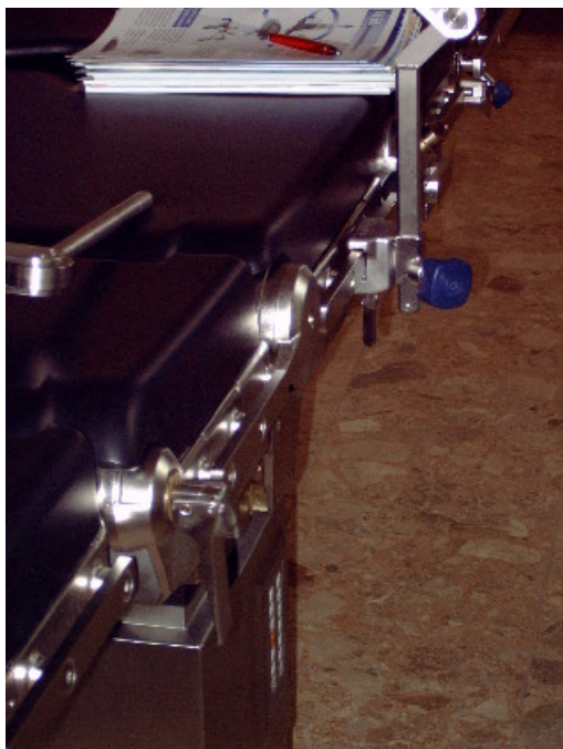
Foto 4.1 De appendagerail van de operatietafel waaraan middels speciale koppelstukjes allerlei elementen aan- of afgekoppeld kunnen worden.
